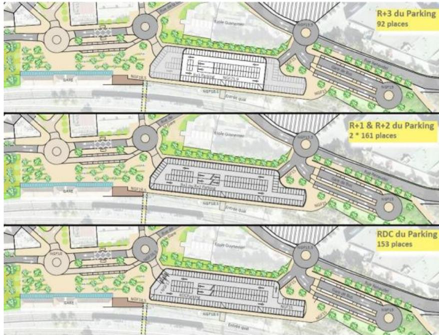
Plans de fonctionnement des différents niveaux de parking
