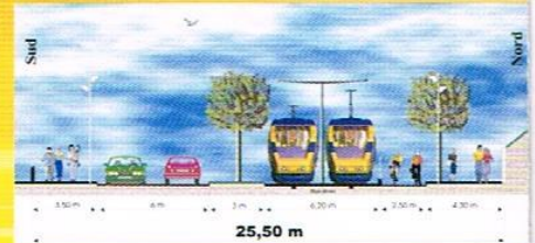
Partage de la voirie sur la RN8 avec création d'une piste cyclable
