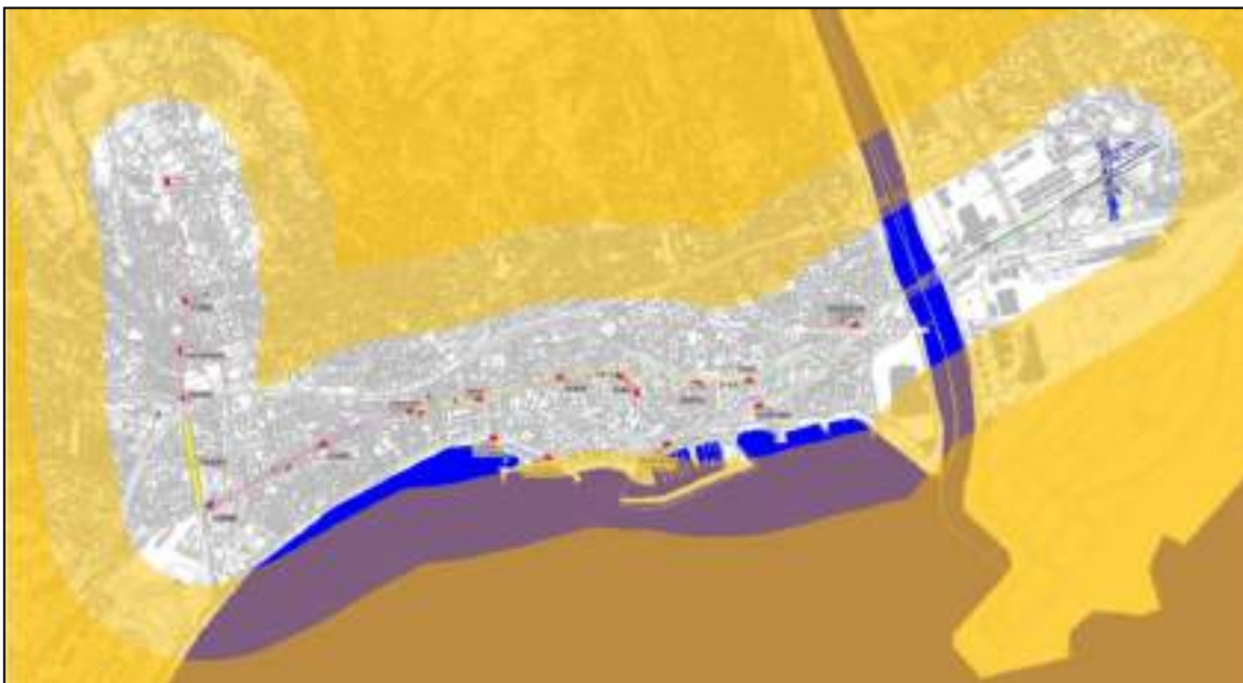
Carte de zonage des 500 et 800 mètres depuis le tracé préférentiel. La zone blanche correspond à la bande de 500 mètres, et le jaune clair à la bande de 500 à 800 mètres depuis l'axe tramway ; Le jaune foncé correspond à la zone supérieure à 800 mètres
